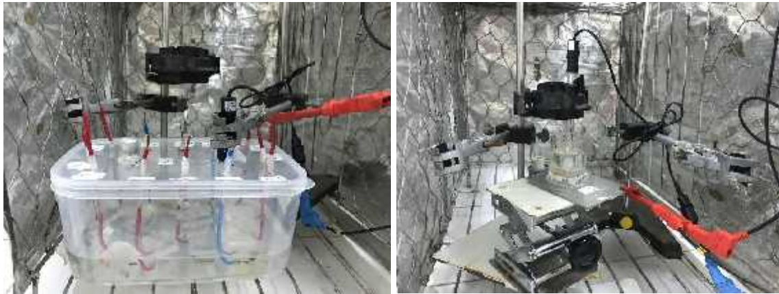
Hệ đo điện thế theo thời gian: a/ Mẫu mặt cắt ngang; b/ Mẫu bề mặt
