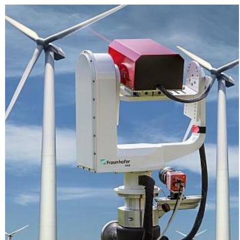
Hình 9: Đo cánh turbine gió với laser tracker
