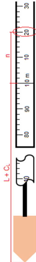
Hình 2. Xác định giá trị thực của thước cuộn quả dọi tại từng vị trí
